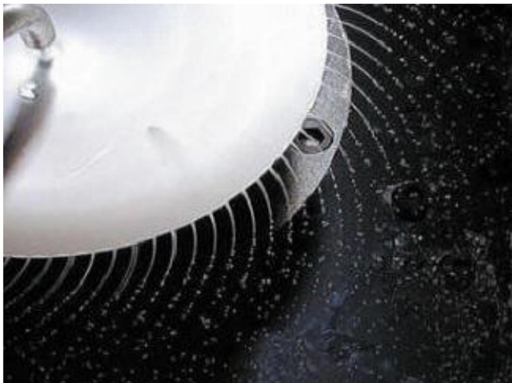
**Figura 8 - Sistema de atomização por disco rotativo.**
