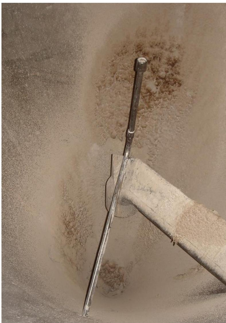
**Figura 5 - Vista interna da câmara de secagem de um sistema de alimentação por “lança” em um *spray dryer* – unidade SENAI “Mário Amato”, Diadema/SP. Suspensão de Cerâmica.**
