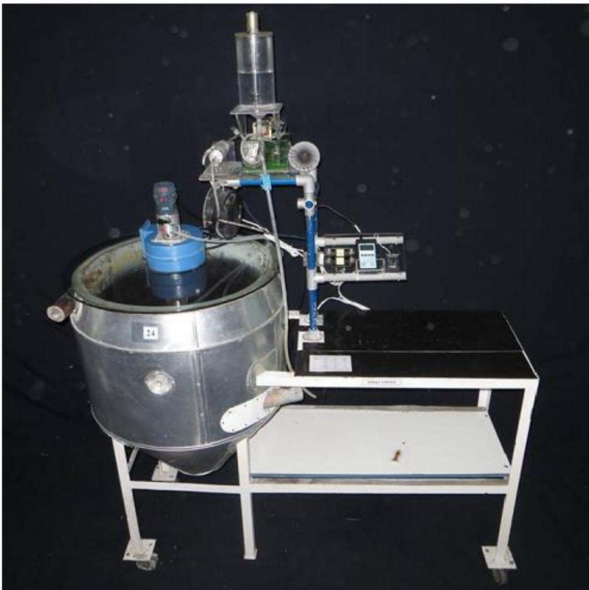
Figura 11 - Equipamento do tipo *spray dryer* utilizado nos experimentos.
