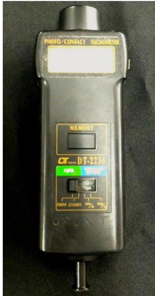
Figura 20 - Tacômetro utilizado para medir a rotação dos experimentos.
