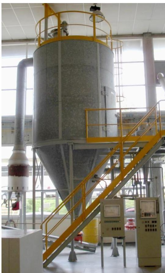
**Figura 3 - *Spray dryer* da unidade SENAI “Mário Amato”, Diadema/SP. Suspensão de Cerâmica.**
