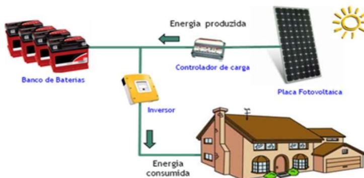
**Figura 10 - Sistema fotovoltaico isolado.**
