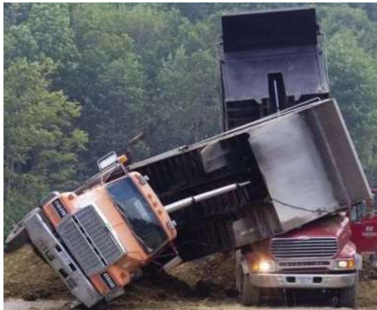
Figura 2 – Tombamento do caminhão durante o basculamento.
