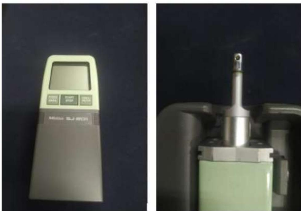
Figura 16 – Equipamento de medição da rugosidade.
