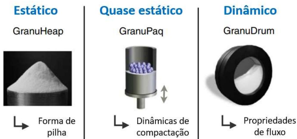
Figura 6 – Métodos de medições para caracterizar as propriedades macroscópicas de materiais granulares.
