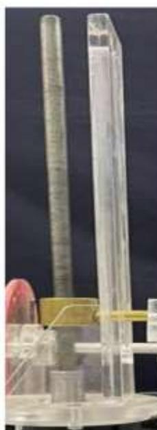
Figura 13 – Fuso roscado com 400mm de comprimento.
