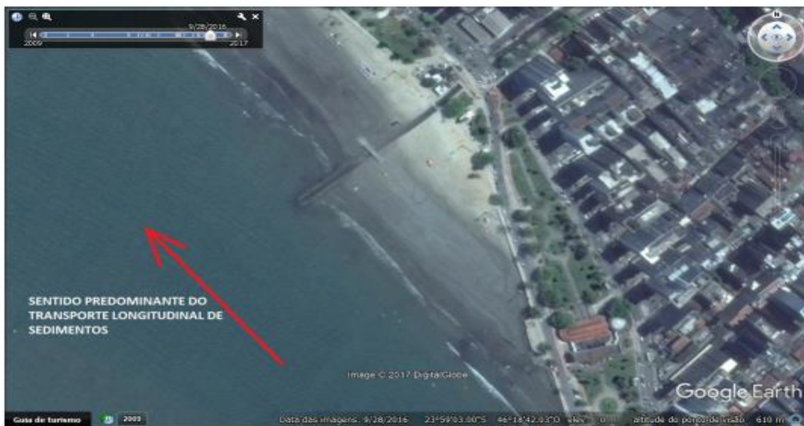
Figura 31. Sentido do transporte longitudinal de sedimentos na Ponta da Praia. Fonte: Venâncio, 2018.
