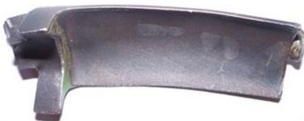
Figura 50 – Vista frontal da palheta quebrada (2007).
