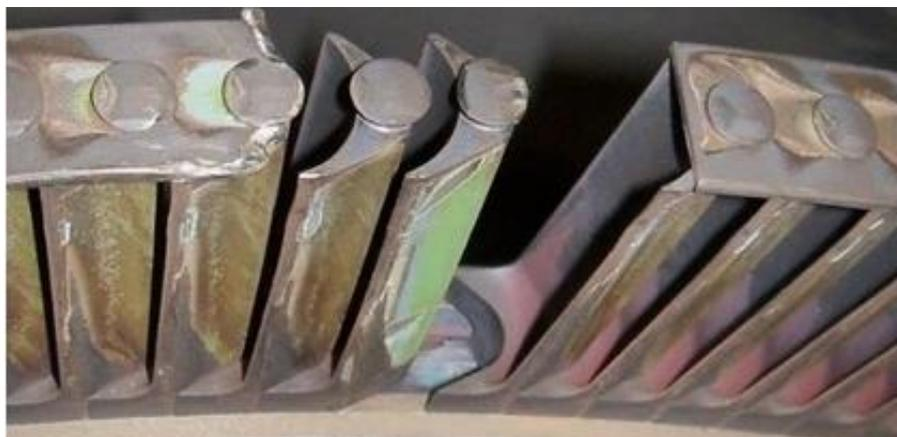
**Figura 2 – Detalhe da região da falha da palheta da turbina.**
