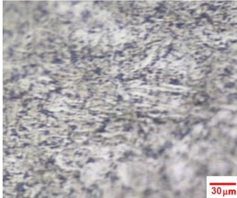
**Figura AP-4.02 – Microestrutura encontrada no material da palheta, no sentido longitudinal, (400x).**
