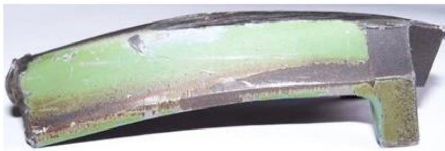
Figura 51 – Vista lateral da palheta quebrada do rotor da turbina (2007).
