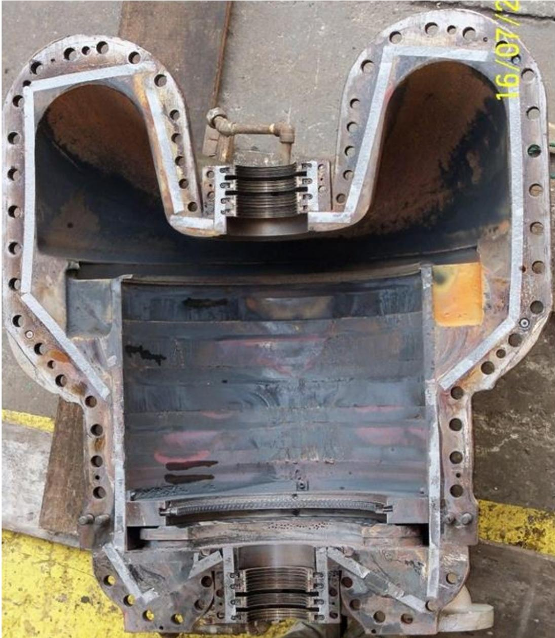
**Figura 5 – Parte superior da carcaça da turbina.**
