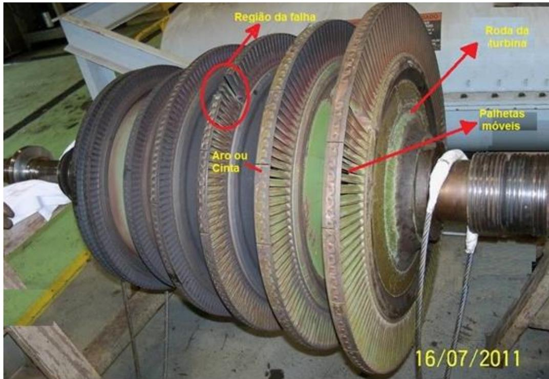
**Figura 1 – Rotor da turbina em estudo TERRY® modelo F6.**
