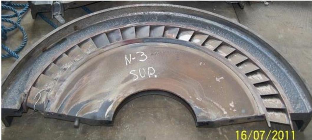
**Figura 3 – Palhetas fixas ou injetores, também chamado de diafragma da turbina.**
