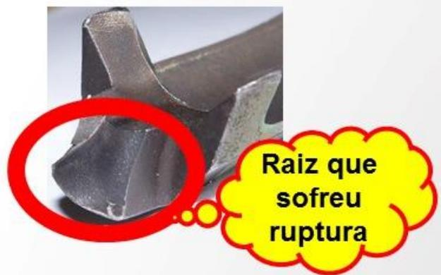
Figura 52 – Vista do detalhe da fratura na raiz palheta quebrada (2007).
