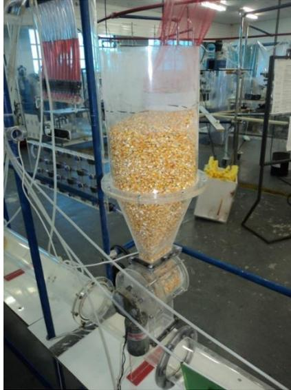
**Figura 21 – Silo para armazenamento dos grãos de milho.**
