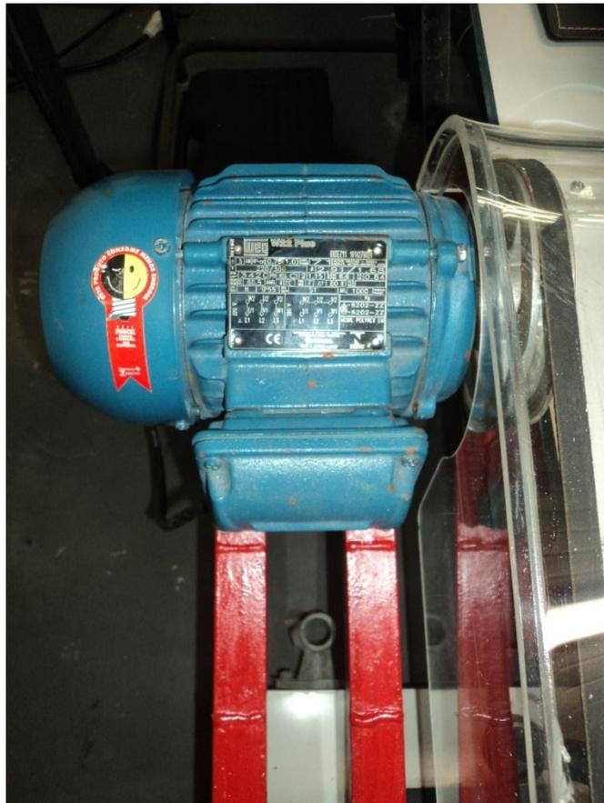
Figura 14 – Motor Elétrico utilizado para acionar o Ventilador da Unidade.
