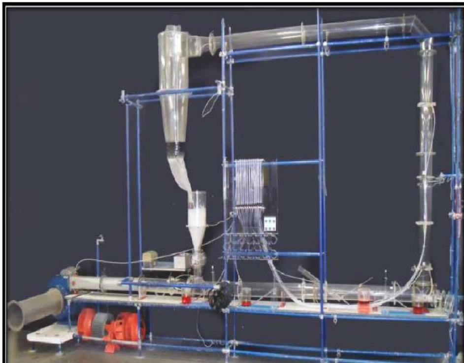
**Figura 10 – Foto da Unidade Piloto de Transporte Pneumático Projetada e Instalada no Laboratório de Operações Unitárias da UNISANTA. (MORAES, 2012).**
