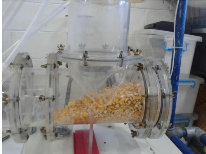
Figura 23 – Detalhe da singularidade Tê Saída de Lado sem prolongamento.
