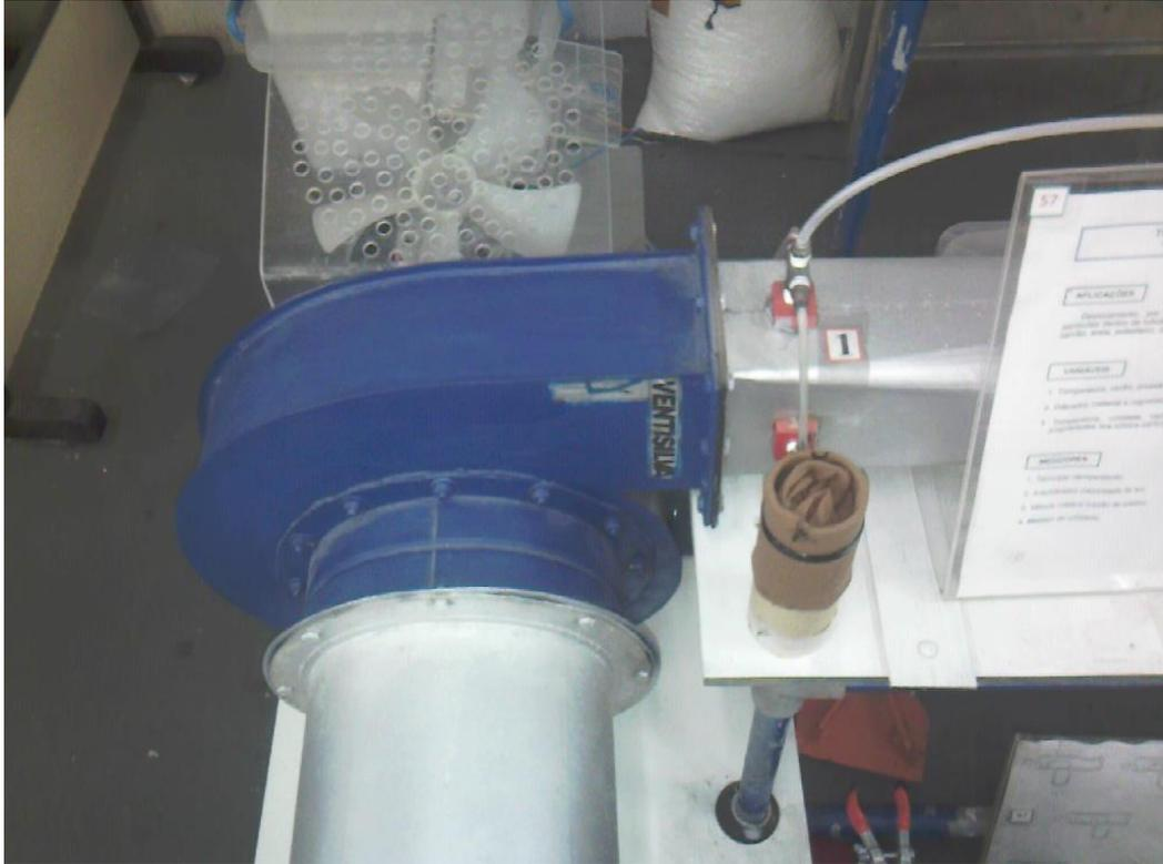
Figura 12 – Ventilador Centrífugo.
