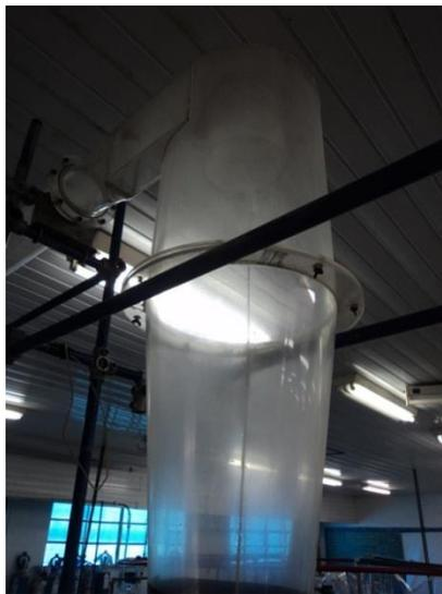
**Figura 22 – Detalhe do Equipamento que ocasiona o efeito Ciclone no transporte dos grãos de milho.**
