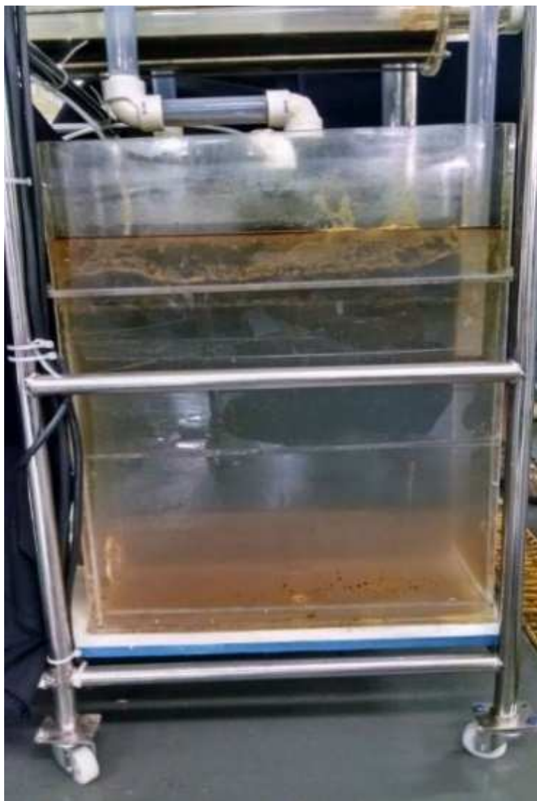
Figura 4.4 – Tanque de óleo de 74 litros.
