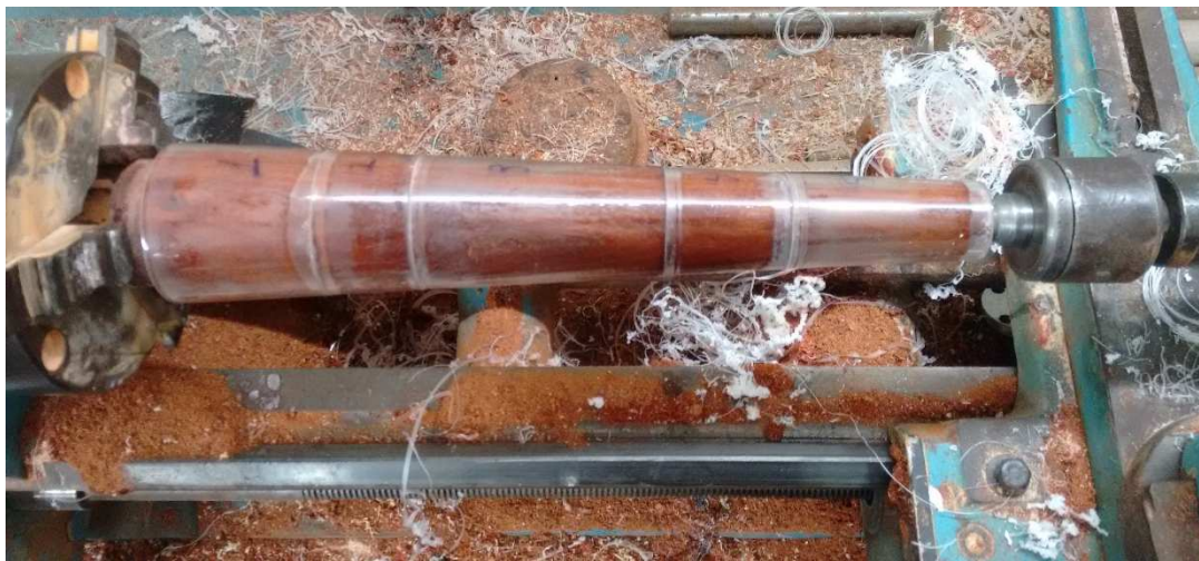
Figura 4.27 – Construção do molde da parte inferior do hidrociclone.
