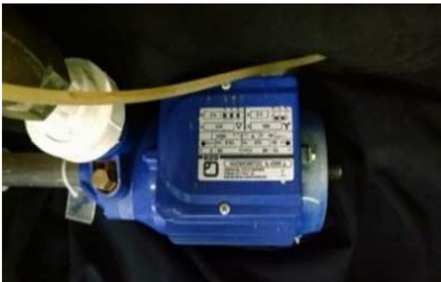
Figura 4.6 – Bomba regenerativa de 0,9 HP.
