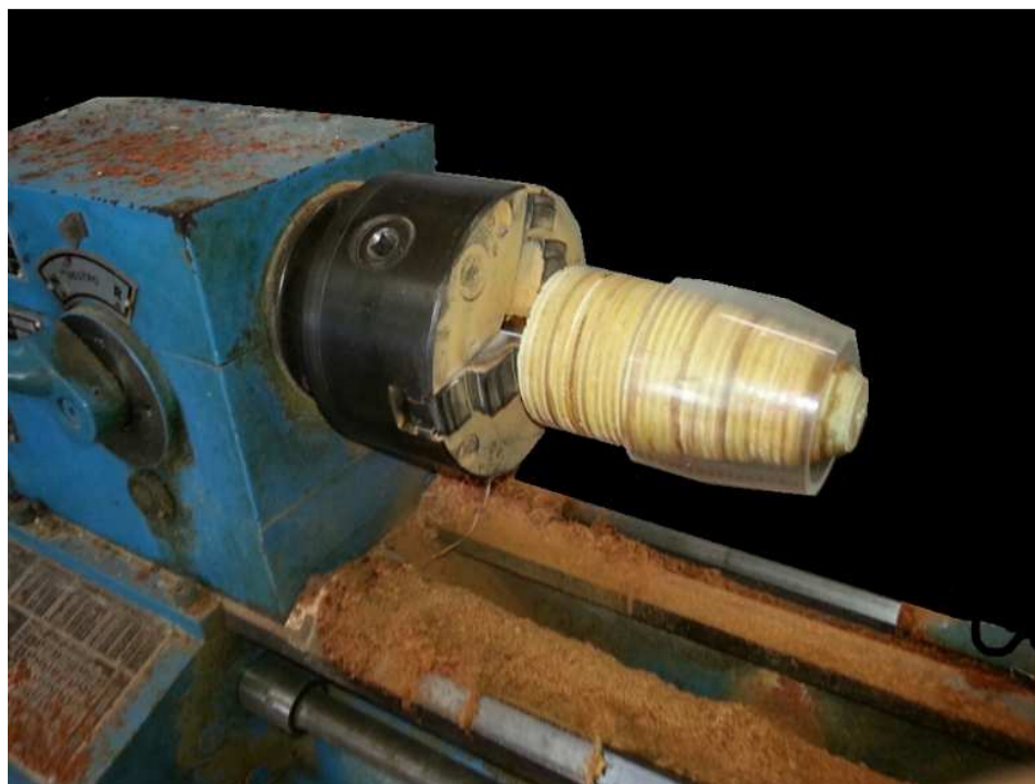
Figura 4.28 – Construção do molde da parte superior do hidrociclone.
