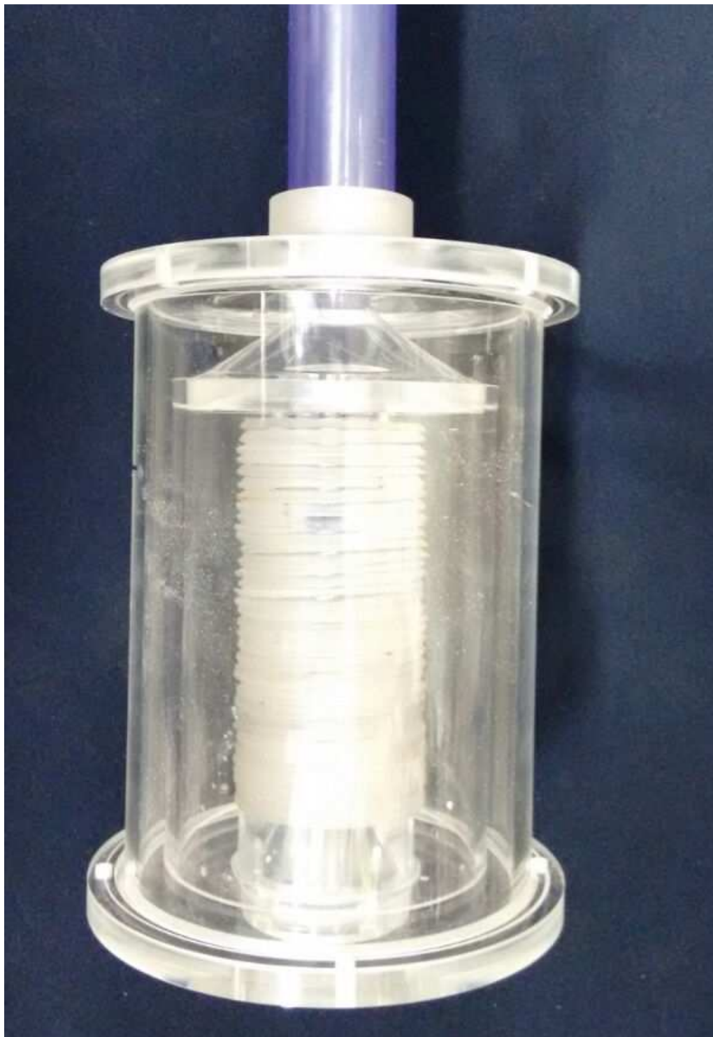
Figura 4.21 – Dispositivo de placas coalescentes para formação em duto vertical do sistema “Core Annular Flow”. Altura de 180 mm.
