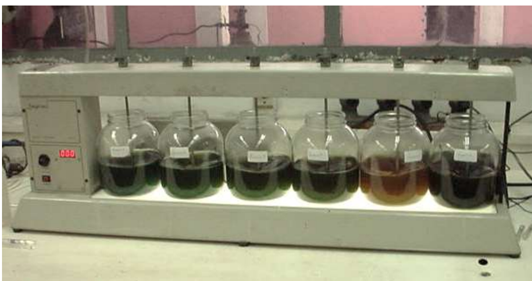
Figura 34 – Equipamento de “jar test” em uso.
