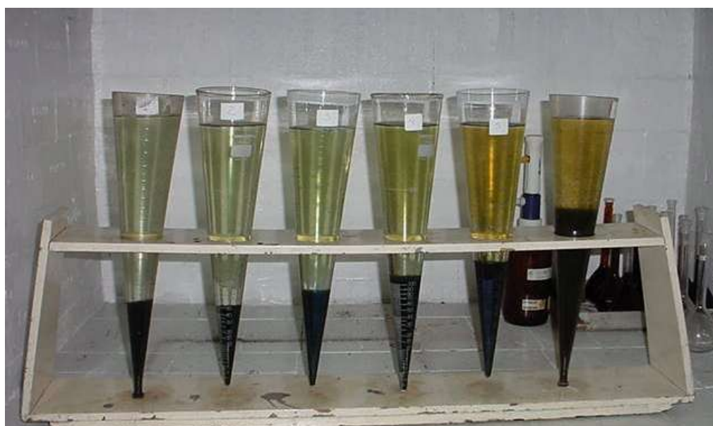
Figura 35 – Avaliação qualitativa da massa de lodo gerado por tipo de reagente.
