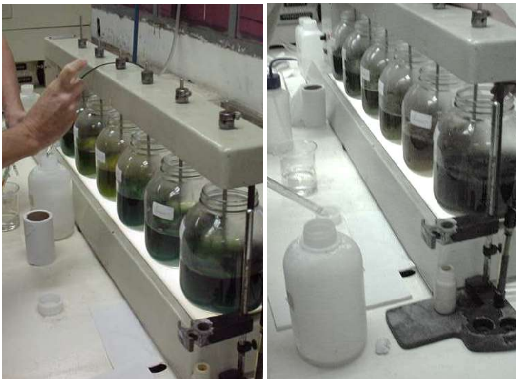
Figura 33 – Dosagem de produtos químicos nos jarros dos ensaios.
