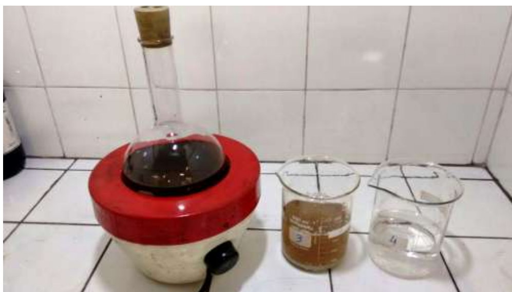
Figura 39 – Aquecedor e balão utilizados nos testes, com amostras de mistura preparada (efluente + escória) e de residual líquido obtido após destilação.
