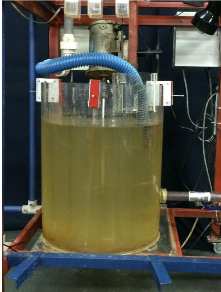
**Figura 3.2 - Tanque de acrílico provido de chicanas com capacidade de 45,35 L.**
