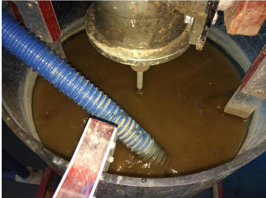
**Figura 3.6 - Mangueira flexível para coleta de polpa.**
