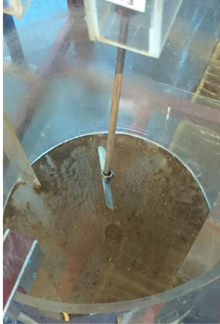
Figura 3.4 - Agitador do tipo turbina com duas pás inclinadas a 45° acoplado a motor de 0,25 hp.
