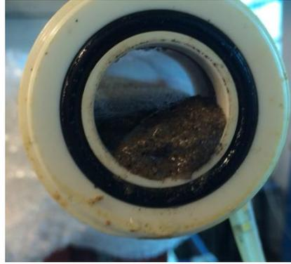
Figura 4.3 - Entupimento na tubulação devido à alta concentração de sólidos gerou necessidade de interrupção do experimento para manutenção da planta piloto.
