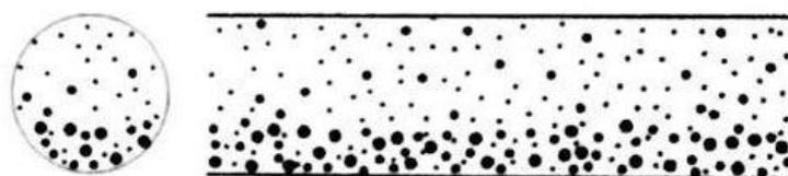
Figura 2.15 - Demonstração de fluxo com leito móvel.
