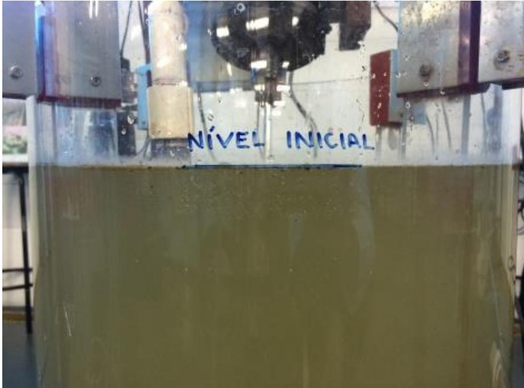
**Figura 3.9 - Tanque de acrílico preenchido com polpa de água e areia até a demarcação determinada experimentalmente para evitar respingos.**
