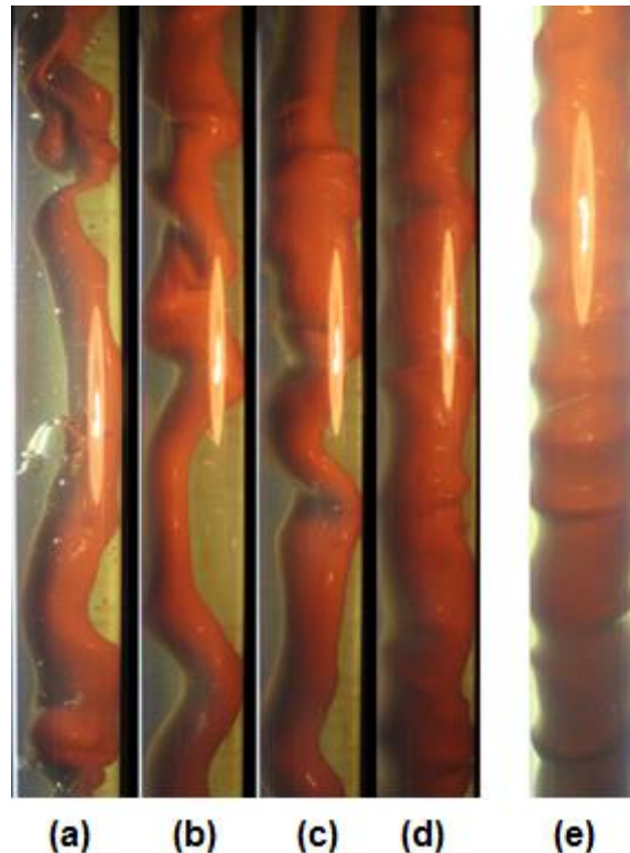
Figura 4.13: Desenvolvimento do perfil CAF: (a) alta vazão de água e baixa de óleo; (b) vazão de água reduzida e mantém-se a de óleo; (c) reduz-se a vazão de água e aumenta-se a de óleo; (d) atinge-se a vazão ideal de óleo e reduz a vazão de água até a formação do perfil ideal; (e) perfil CAF plenamente desenvolvido.
