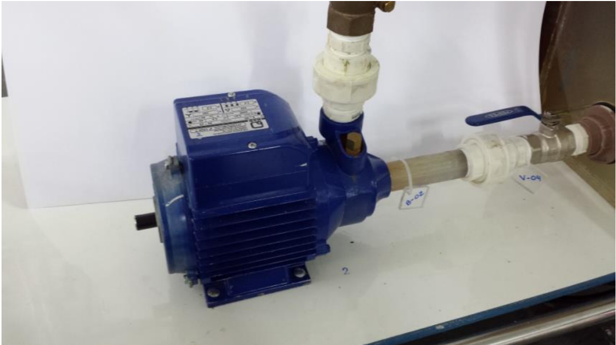
Figura 3.2: Bomba regenerativa com motor trifásico de 1cv modelo KSB-Hydrobloc P1000 T.
