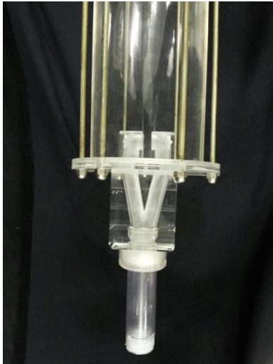
Figura 3.10: Entrada do vaso separador.
