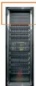
**Figura 19 - *Rack* típico com painel de fechamento.**
