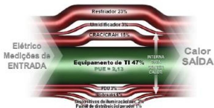
**Figura 8 - Fluxograma de energia através dos sistemas de um *data center* típico.**
