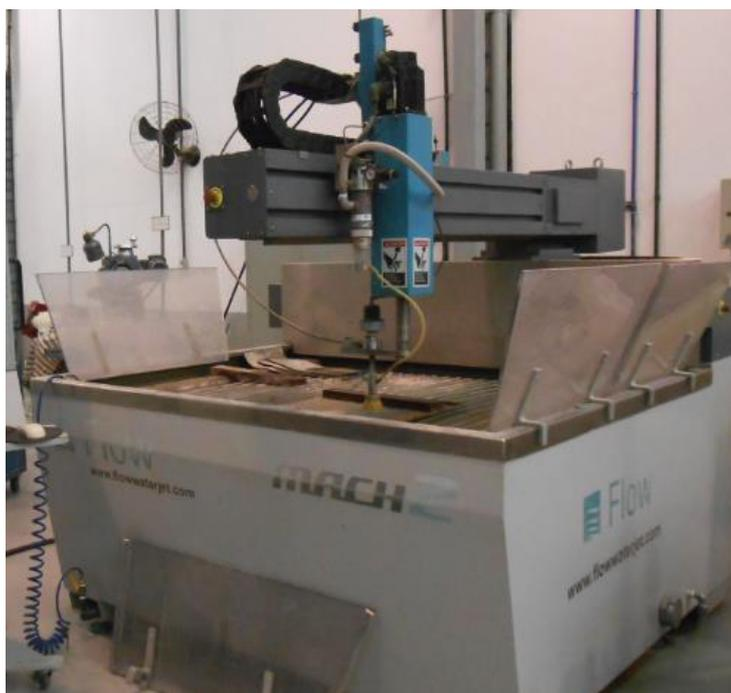
Figura 16 - Máquina de corte com jato de água. (Elaborada pelo autor).
