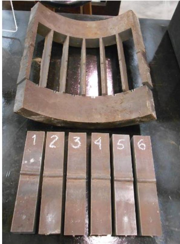
Figura 19 – Local de retirada e identificação dos corpos de prova. (Elaborada pelo autor).
