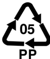
Figura 17 – Símbolo de Identificação do PP segundo a norma ABNT NBR 13230.
