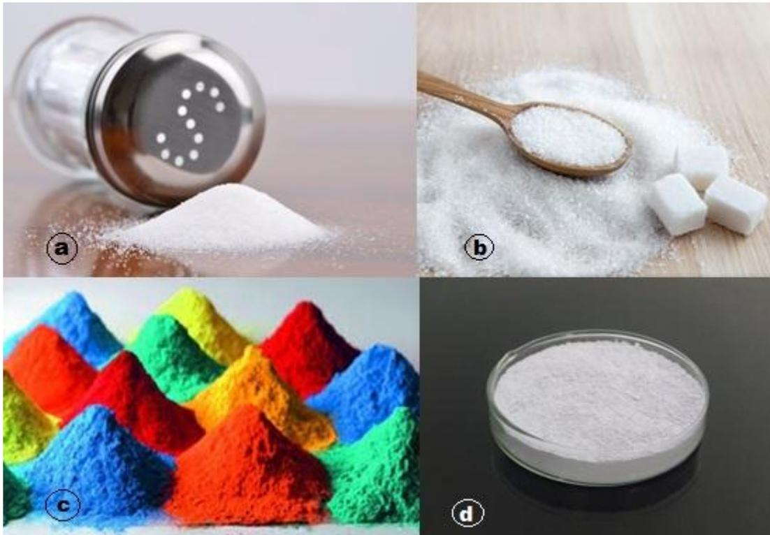
*Figura 12 – Tipos de traçador: (a) sal; (b) açúcar; (c) corantes artificiais; e (d) cloreto de lítio.*
