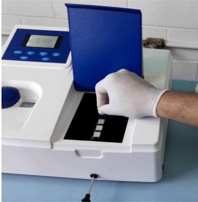
*Figura 25 Cubetas no espectrofotômetro*
