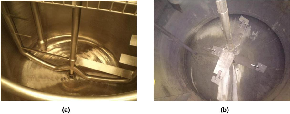
Figura 7 – Impulsores mecânicos: (a) tipo ancora; e (b) Fluxo axial duplo.
