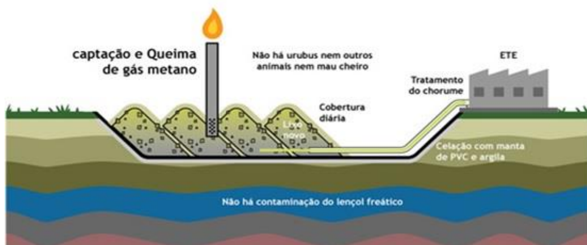
Figura 4. Desenho esquemático de um aterro sanitário. Fonte: Trilho Ambiental, 2019.
