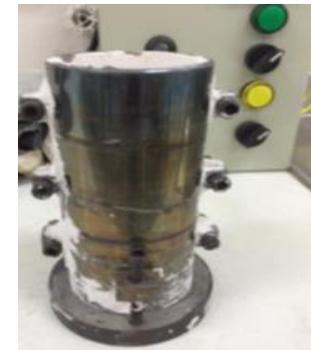
Dispositivo de solidificação unidirecional ascendente vertical: composto de um controlador automático de temperatura. O dispositivo possui um conjunto de placas refratárias, resistências e sistema de refrigeração na base, para a extração de calor da lingoteira pelo molde na parte inferior.
