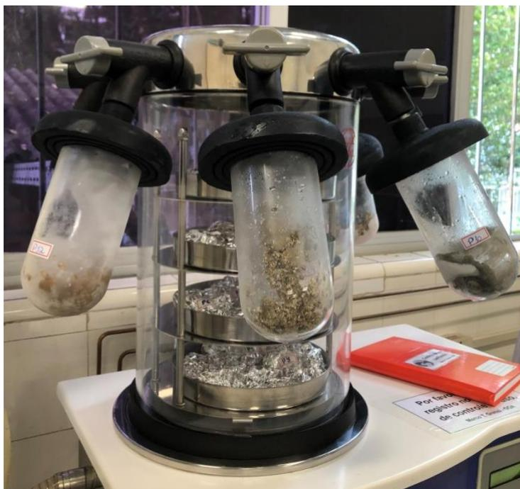
Figura 2 - Liofilização de amostras de sedimento para retirada de umidade.
