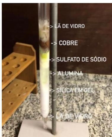
Figura 4 - Coluna cromatográfica de vidro recheada de baixo pra cima com lã de vidro,  $\text{SiO}_2$ ,  $\text{Al}_2\text{O}_3$ ,  $\text{Na}_2\text{SO}_3$ , Cu e lã de vidro.
