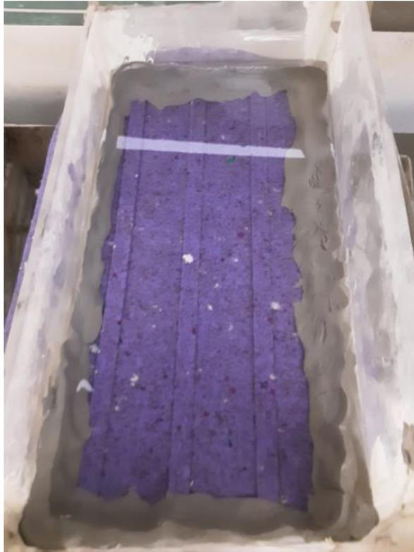
Figura 9. Corpo de prova submerso em água, isolado em recipiente impermeável para determinar a permeabilidade.
