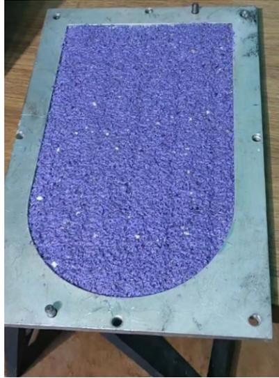
Figura 4. Material em estado de fusão, pós estar no forno por aproximadamente 2 horas a 200°C.
