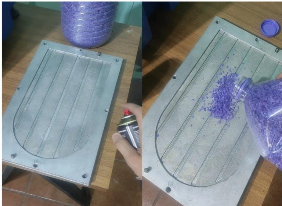
Figura 3. Aplicação de silicone como desmoldante (Esquerda) e adição do material triturado na forma (Direita).
