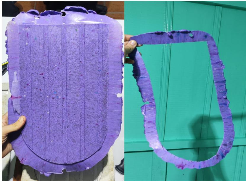
Figura 6. Telha retiradas da forma ainda com rebarba (Esquerda), rebarbas retiradas da telha em estado de acabamento, entorno de 10% (Direita).
