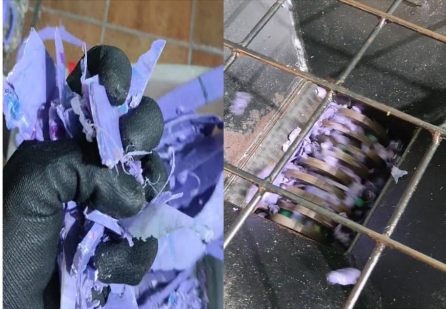
Figura 7. Rebarbas retiradas são armazenadas (Esquerda) e trituradas para voltar a linha de processo (Direita).
