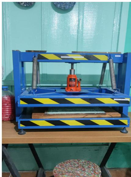
Figura 05. Forma inserida na prensa hidráulica para ser submetida a pressão.
