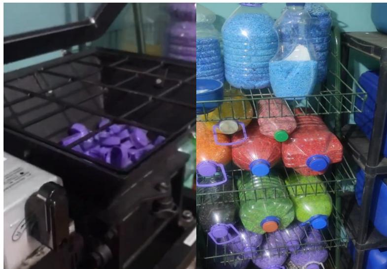
Figura 2. Tampinhas limpas e triadas, dentro do triturador para serem trituradas. (Esquerda) e armazenamento do material triturado, organizado e separado por cor. (Direita)
