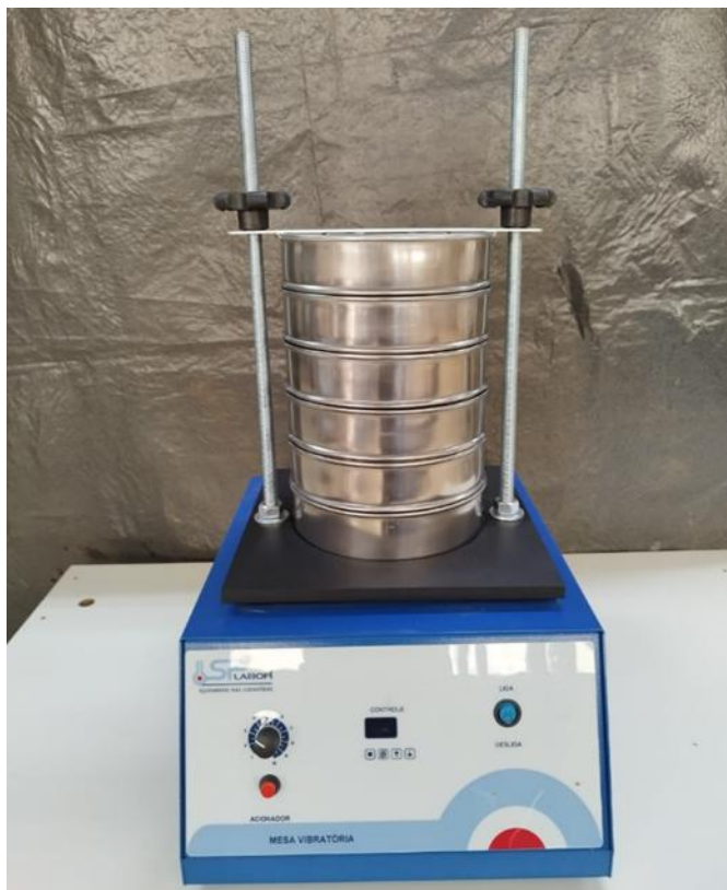
Figura 31 – Ensaio de granulometria. (Fonte: autor)
