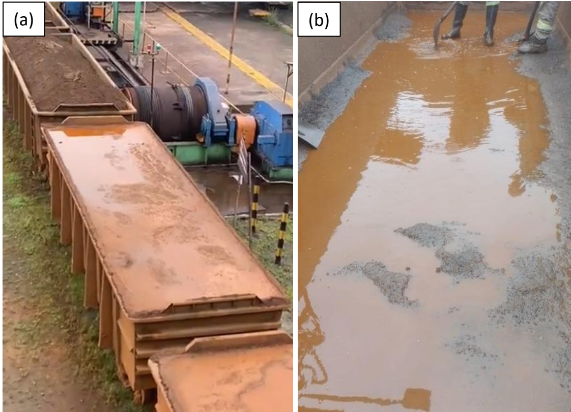
Figura 7 - Vagões de minério com formação de água livre (a) e recheio de minério no assoalho (b).
