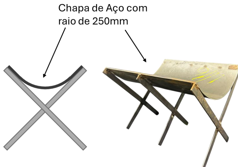
Figura 19 – Placa de aço com raio de 250mm para o ensaio de Sticking .
