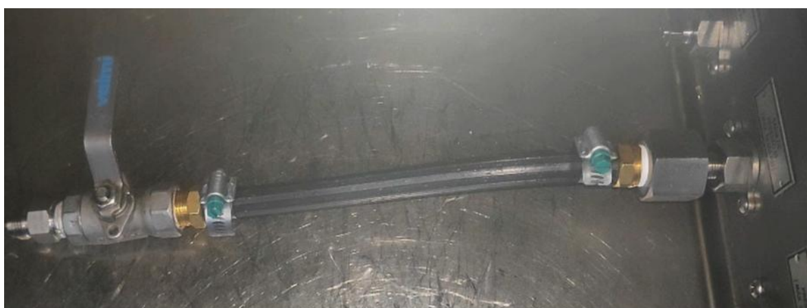
Figura 20: Ensaio de ruptura da mangueira feita com a blenda SENAI/PVC Virgem (50/50).
