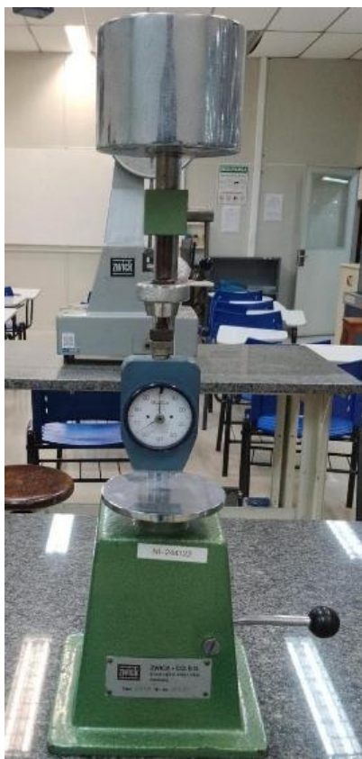
Figura 9: Durômetro Shore Zwickroell, utilizado para medições de Shore A e Shore D.
