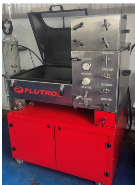
Figura 10: Unidade de testes para identificação da pressão de falha do fabricante Flutrol.
