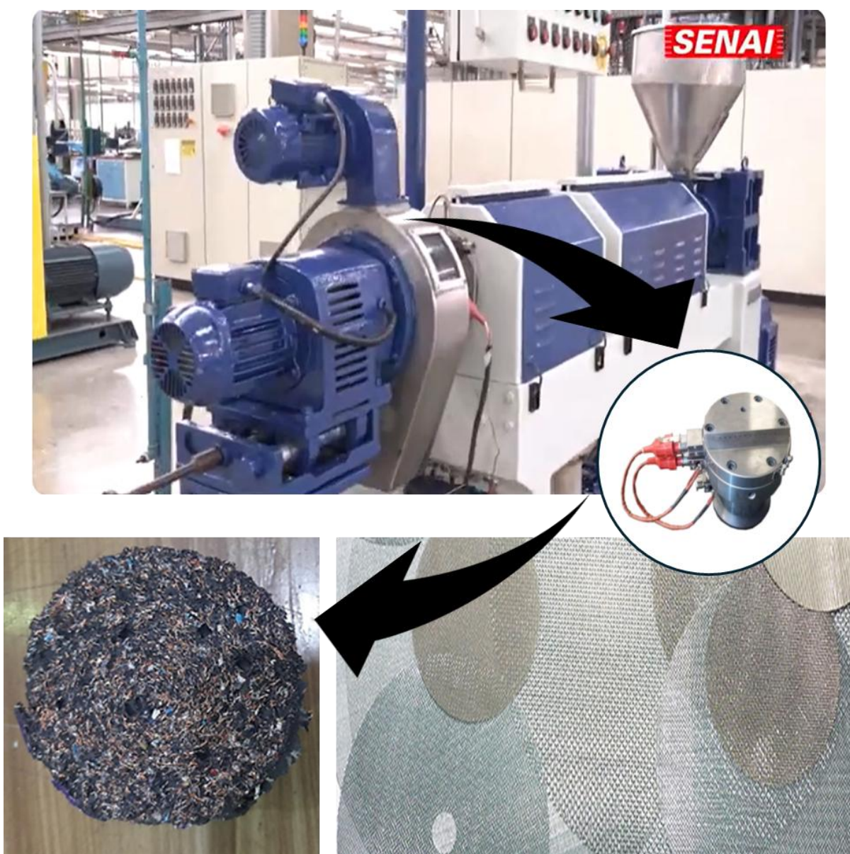
Figura 6: Extrusora granuladora Miotto. No detalhe, o cabeçote da extrusora em que a tela foi acoplada e o material retido após o primeiro ciclo de processamento, demonstrando a grande quantidade de resíduos removidos.
