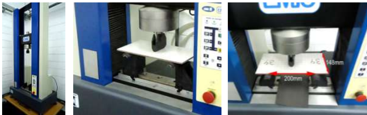
Figura 1 - Máquina de ensaios universal EMIC DL10.000 empregada no trabalho, posicionamento e dimensões das placas cerâmicas nos ensaios de flexão a três pontos.
