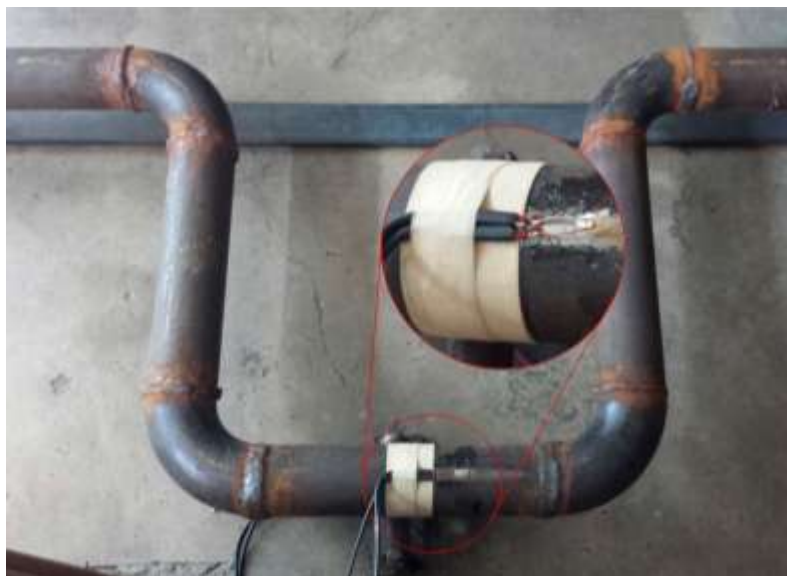
Figura 2 – Aplicação dos Strain Gages
