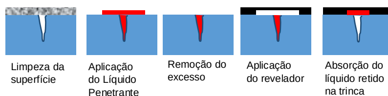
Figura 1: Etapas do ensaio de líquido penetrante – adaptada de Andreucci, (2006).
