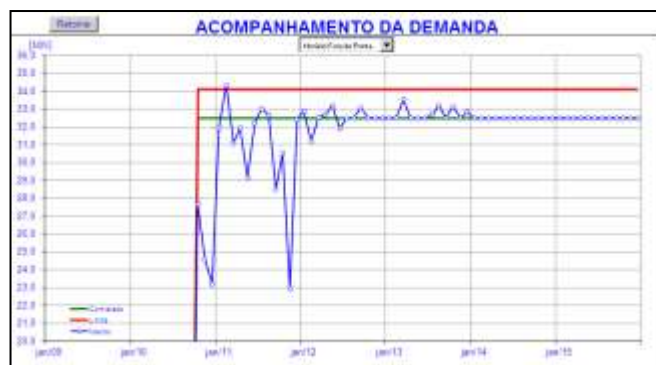
Figura 10 – Tela referente ao acompanhamento da demanda de energia elétrica no horário fora de ponta (Fonte: Arquivo Excel “SIE Araxá”).
