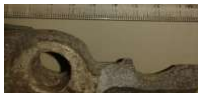
Figura 1 B – Detalhe da fratura
