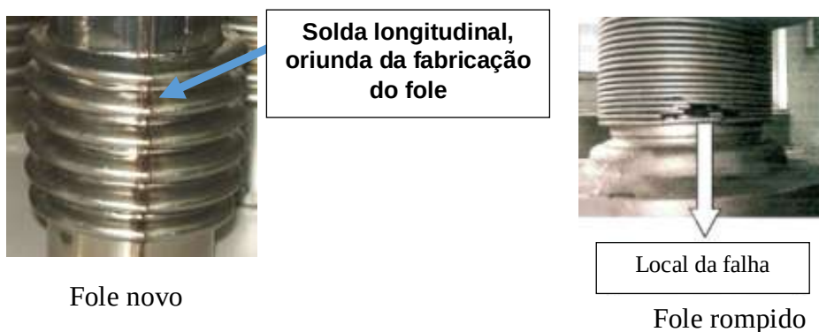
Figura 5: Foles novo e rompido
