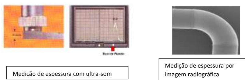
Figura 5: Medição de espessura – adaptada de Andreucci, (2005)
