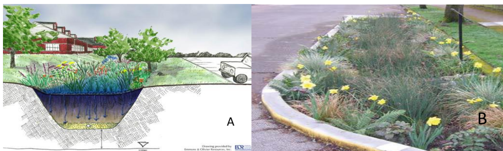
Figura 1: Jardim de Chuva: A. Croqui mostrando a infiltração da água pela vegetação; B. Foto de um jardim de chuva em Portland (USA) (extraído de: http://blog.dawngriffin.com/ ).
