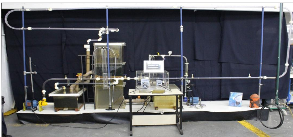
Fig. 5: Unidade Experimental para estudo do CAF - UNISANTA (Barbosa Filho et al , 2013)
