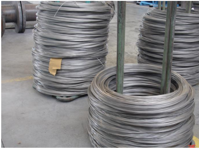
Figura 3 – Fio máquina de aço inoxidável Ø 5,50mm
