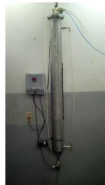
Figura 3 - Tanque construído em aço inox
