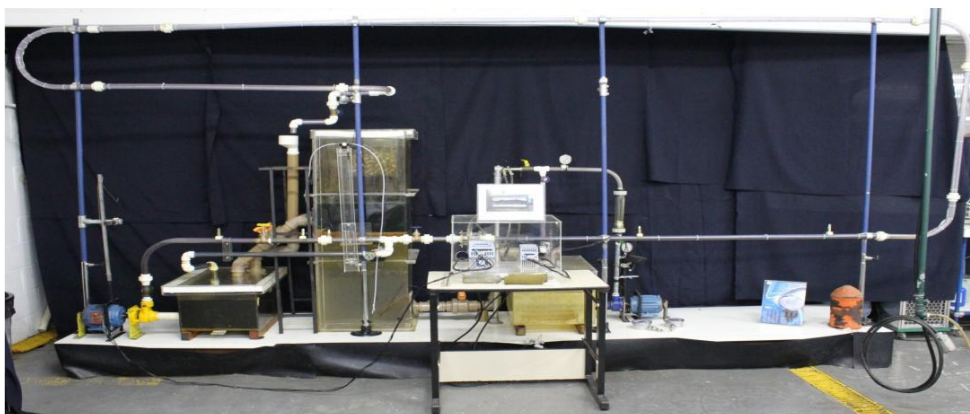
Figura 2: Unidade Experimental para estudo do CAF - UNISANTA (BARBOSA FILHO et al, 2013)
