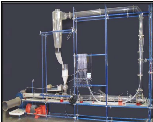
Figura 1 – Unidade Piloto de Transporte Pneumático Projetada e Instalada no laboratório de Operações Unitárias da Unisanta (Moraes, 2012)
