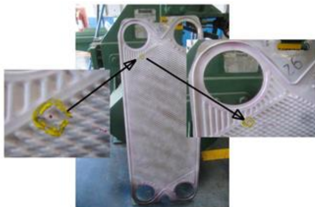
Fig. 2: Vista da identificação do dano após ensaio com Líquido Penetrante.
