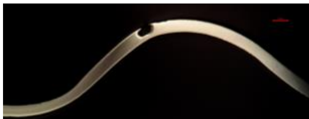
Fig. 4: Vista da seção transversal do pite para caracterização do dano e dimensionamento
