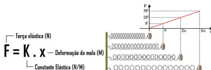
Figura 5. Fórmula da Lei de Hooke e conceito da deformação.
