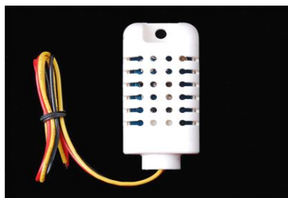
Figura 2 – Sensor de Temperatura e Umidade DTH 22 Fonte: Especificação Técnica, 2015a
