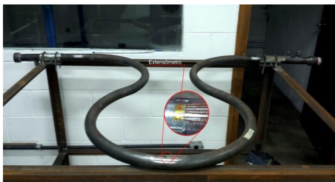
Figura 1 – Instalação dos extensômetros no modelo (Pelo autor)
