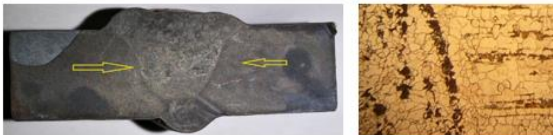
Figura 4. Macrografia e Micrografia metalográfica do metal base, próximo à ZTA (ataque: Nital a 2% e ampliação ótica de 50X).
