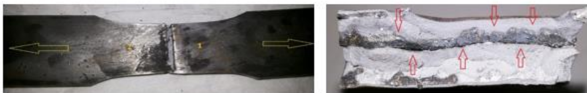
Figura 3. Resultados visuais dos CPs de tração rompido e seção transversal da fratura obtida.
