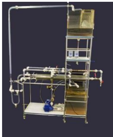
Figura 1– Equipamento utilizado para formação de Core Annular Flow , projetado e construído no Laboratório de Operações Unitárias da Universidade Santa Cecília.
